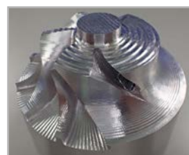
Poškození během obrábění
